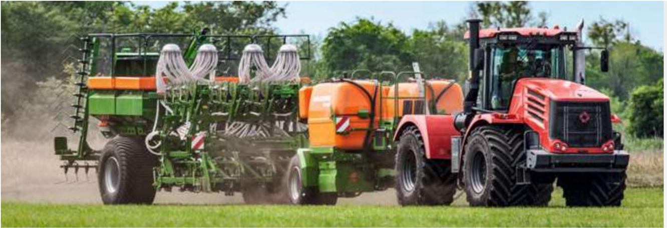
FDC 6000 mit Sämaschine Primera DMC 9001-2C in Transportstellung
