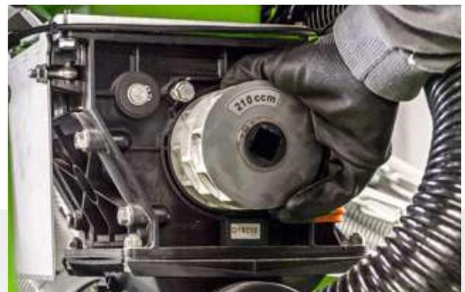
Einfacher Wechsel der Dosierwalzen für verschiedene Saatgutmengen und -arten
