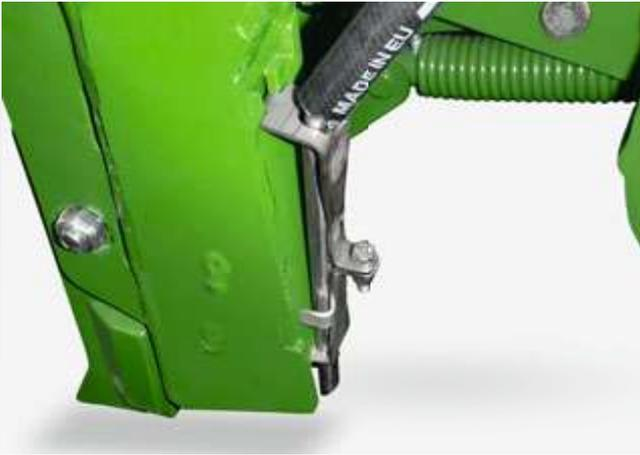
Saubere Schlauchverlegung der Düngerschläuche zum Auslauf am Meißelschar der Primera DMC
