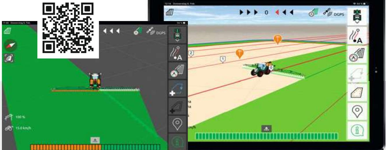
Kartenansicht mit AmaTron Twin – Übersichtliche Darstellung der Arbeitsmaschine und ihrer Teilbreiten sowie Schaltflächen auf der rechten Seite des Tablet-Displays
