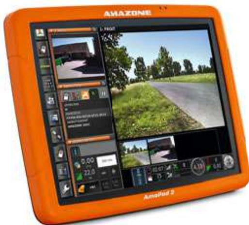
Zwei Kameras ermöglichen die stetige Überwachung des Umfeldes während der Feldarbeit oder auf der Straße
