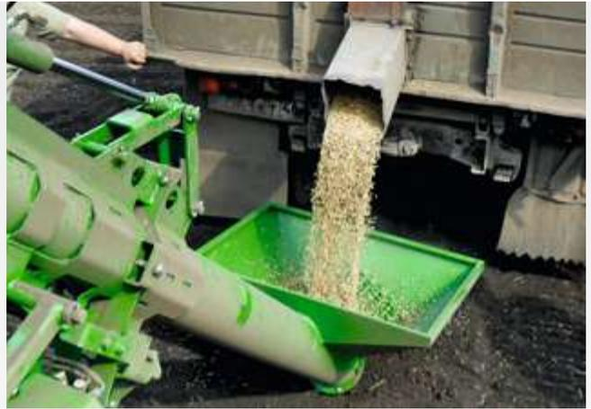
Primera DMC 9001-2C mit Befüllschnecke
