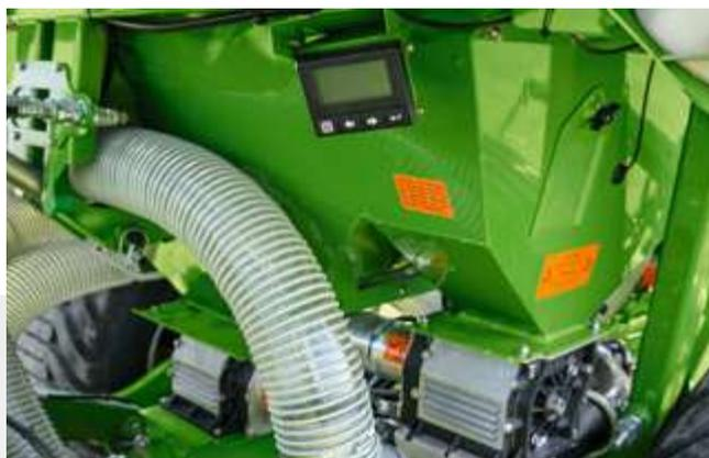
Primera DMC mit elektrischem Dosierantrieb und TwinTerminal 3.0
