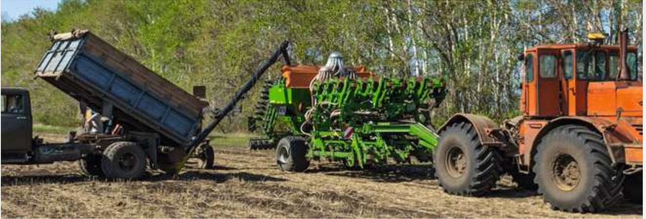
Große Einfüllöffnung zum Befüllen mit Frontladern und Befüllschnecken.
